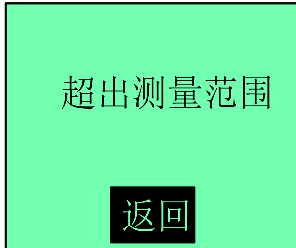
图 8 线圈电阻过大，超量程
