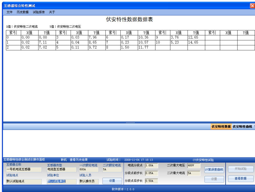
图 6.1.3 CT 伏安特性试验结果显示
