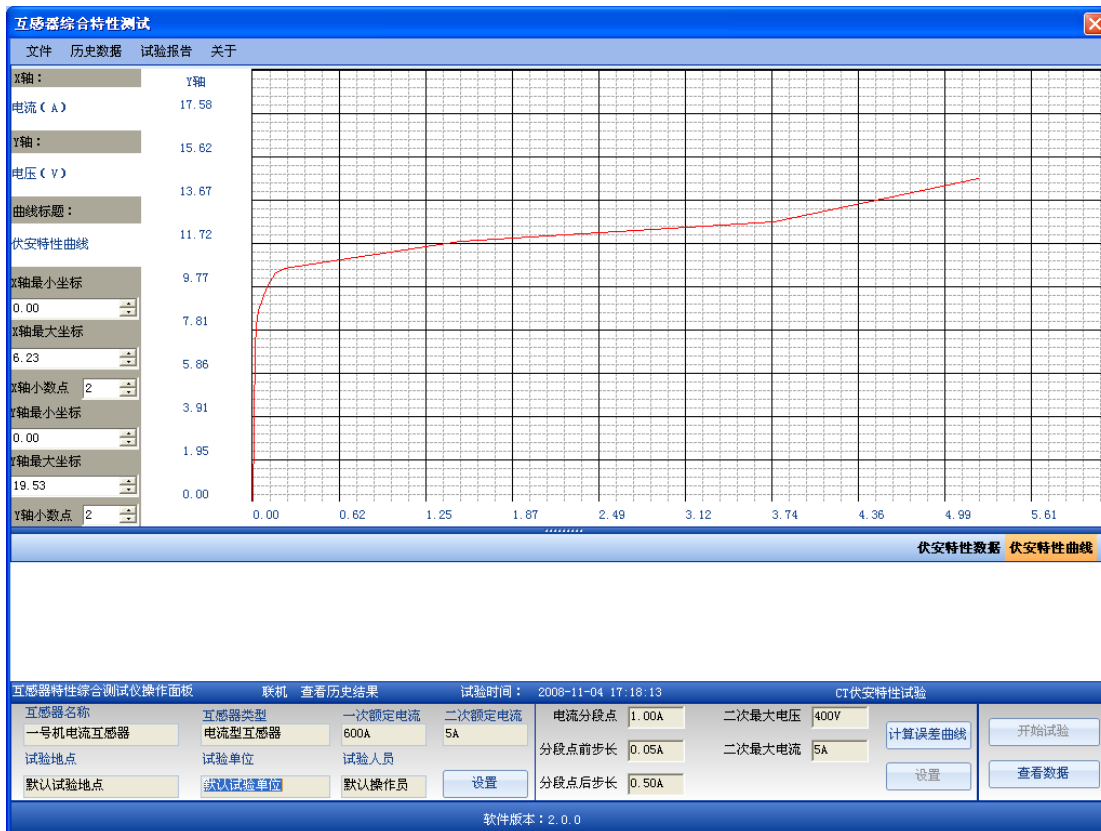
图 6.1.4 PT 伏安特性试验结果显示
