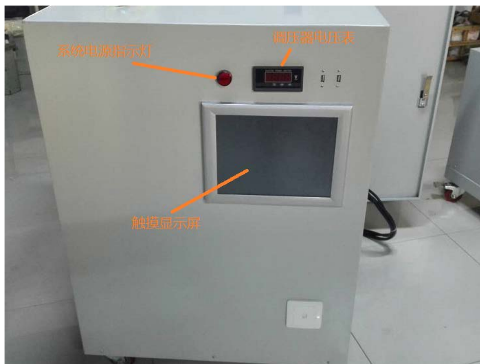
图 5.2 HYCTDW 电流互感器短时热电流自动化试验装置控制箱
